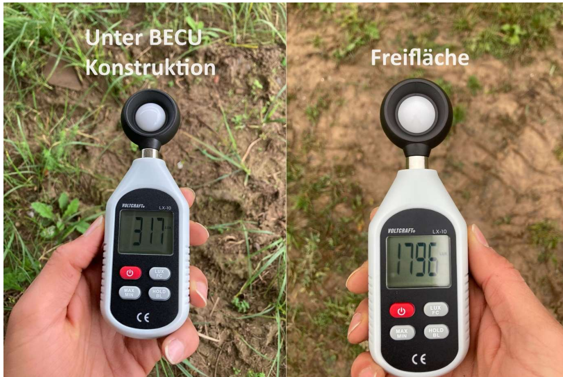
Abbildung 2: Links Gemessene Lichtintensität unter dem PV-Modul. Rechts: Gemessene Lichtintensität außerhalb des PV-Moduls.
